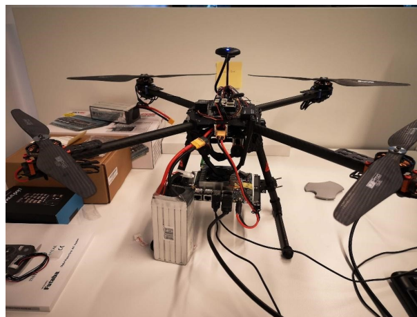
FIGURE 5.7 – Intégration Mini-Ordinateur au Drone.
